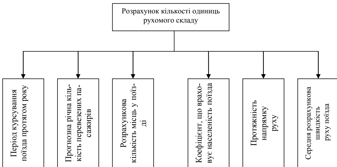
Рис. 2. Принцип розрахунку кількості пасажирських високошвидкісних поїздів на заданому напрямку руху
