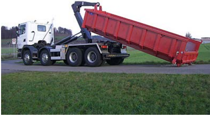
Рис. 1. Звільнення важковагового автомобіля від контейнера з допомогою технічної системи «мультиліфт»
